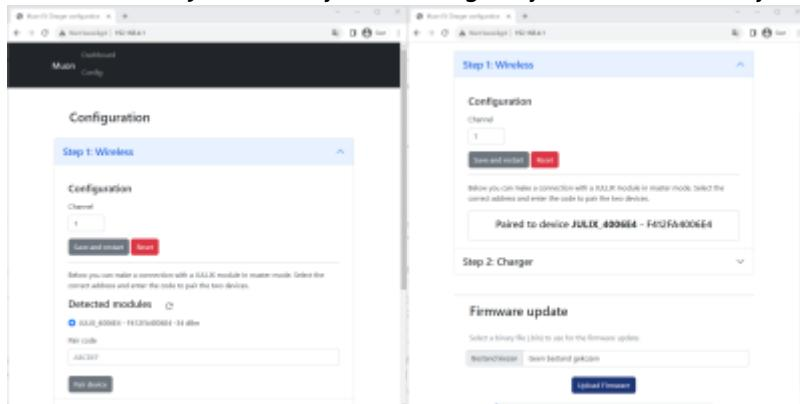
Als de paircode juist is, zal Muon een directe wifi-verbinding maken met Jullix. Je ziet dit ook op het dashboard van de laadpaal. **Je kan hier dan ook de signaalsterkte controleren, dit moet hoger zijn dan -85dBm.**
